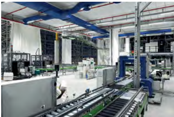
מיון תרופות אוטומטי ומערך ליקוט רובוטי המופעלים באמצעות הזמנה ממחושבת, ללא מגע יד אדם
