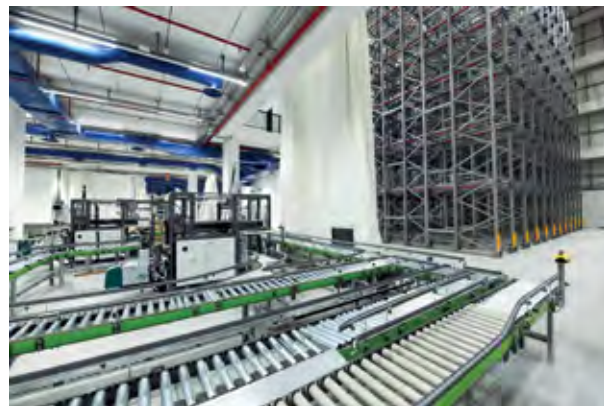
מיון תרופות אוטומטי ומערך ליקוט רובוטי המופעלים באמצעות הזמנה ממחושבת, ללא מגע יד אדם
